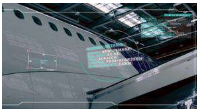
Inspection d'un aéronef en réalité augmentée : l'opérateur est guidé dans son action
