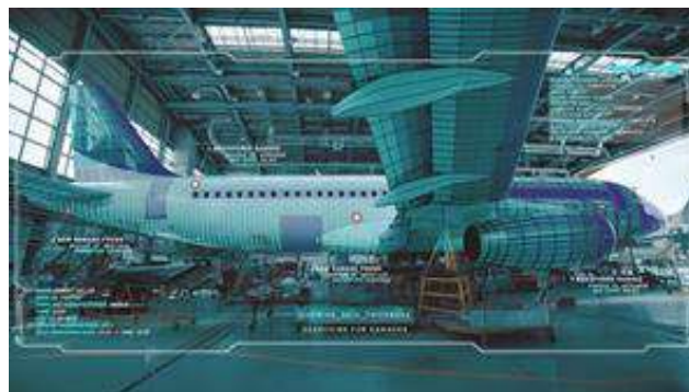
Montage d'un aéronef en réalité virtuelle et augmentée : chaque pièce et sa description sont visualisées
